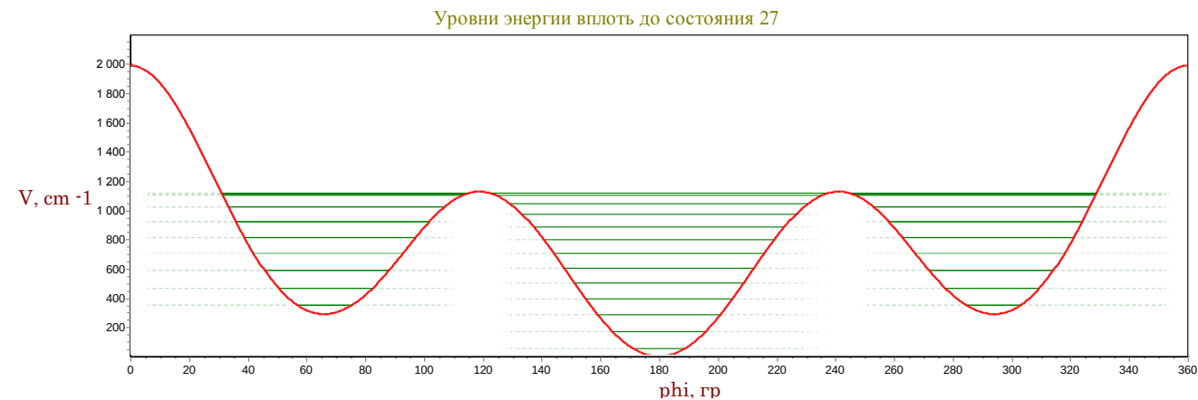
Рисунок. Энергетические состояния в n -бутане (с учетом веса)
